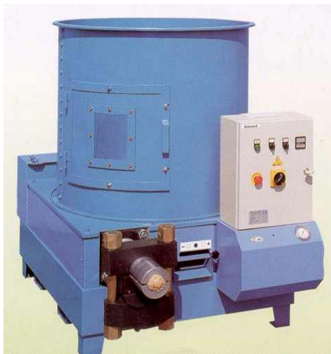
Figura 21 – briquetadeira de rosca sem-fim, importada da Itália ( fonte: POR Ecomec s.r.l. ).
